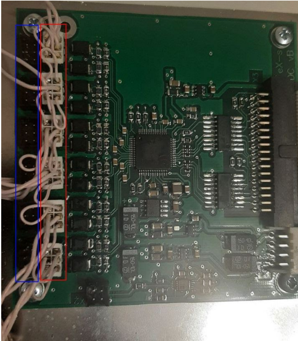
Рисунок 2: Плата АЦП. Красным помечены разъемы без делителя, синим - разъемы с делителем.
